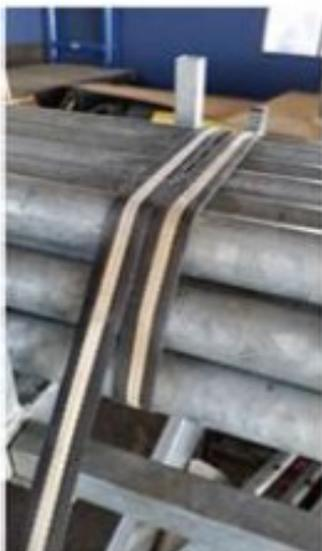
**Très important**, pour maintenir la stabilité des barres pendant le transport, enrouler les 2 sangles autour des barres **SANS INCORPORER LE TUBE CARRE** de la structure de la remorque (voir photo).
